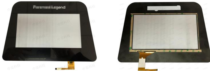
图10 定制盖板+触摸一体化方案
